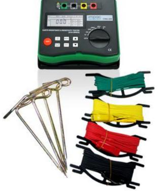
de Wenner , sendo usados 4 hastes ou eletrodos para este tipo de medição. O terrômetro Impac já converte e informa os dados diretamente na unidade de resistividade de solo ou seja " $\Omega$ .m". Neste modo é possível inclusive informar qual é a distância entre as hastes para o correto cálculo da resistividade do solo pelo método de Wenner de acordo com a norma NBR-7117.
